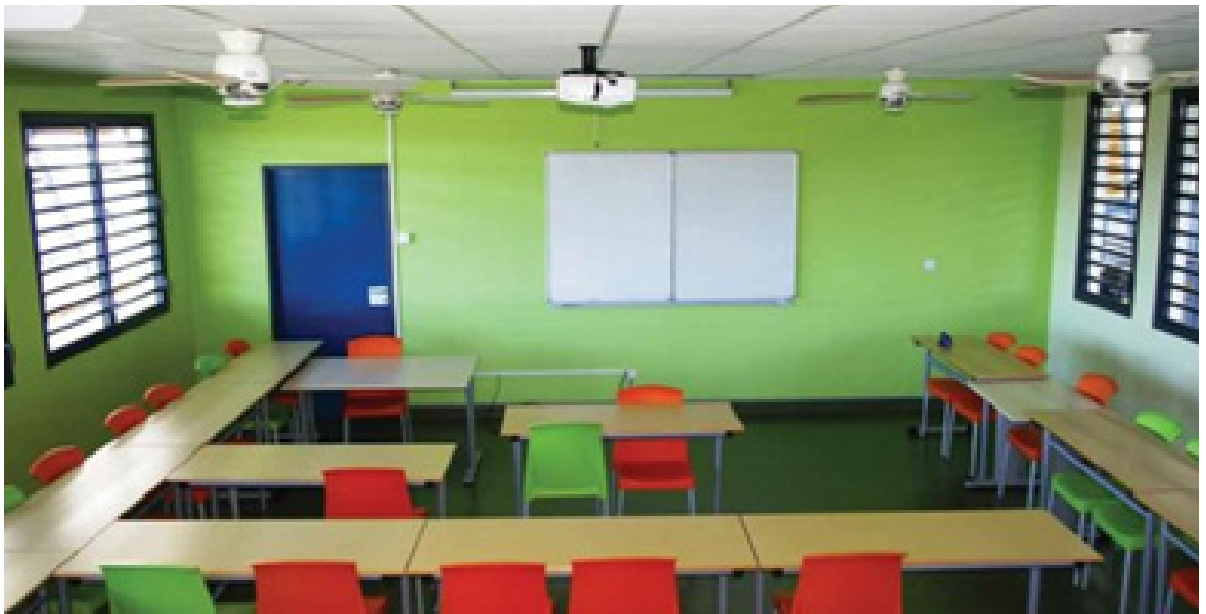
Esempio di ventilazione naturale incrociata e uso di ventilatori per ottimizzare i ricambi d'aria in un'aula didattica (fonte: Post-occupancy evaluation and experimental feedback of a net zero-energy building in a tropical climate; DOI: 10.1080/00038628.2012.702449)
